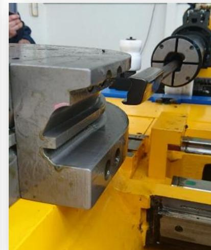
3D-Biegemaschine (für Rohr und Profil)
