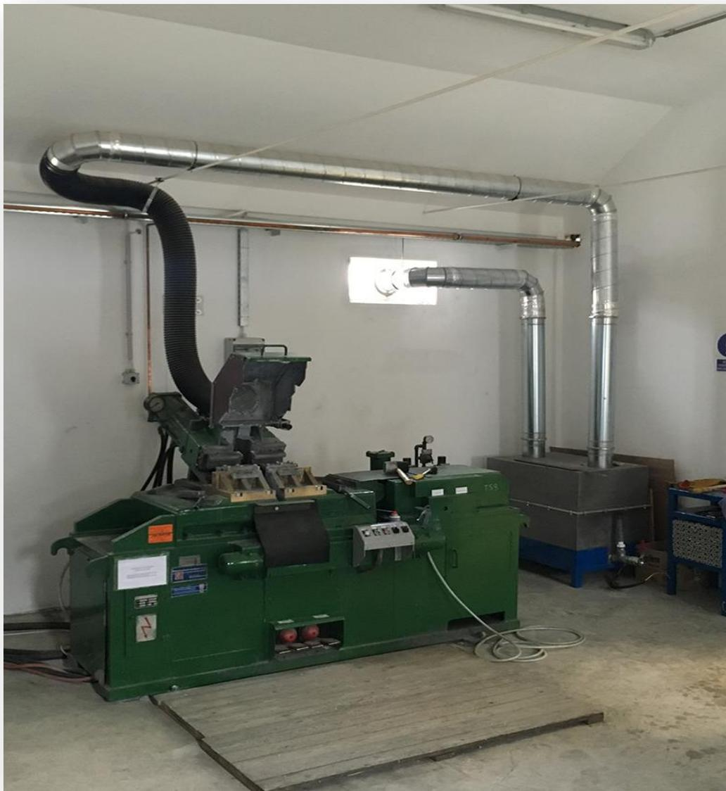
Stumpfschweißgerät (für Aluminium)
